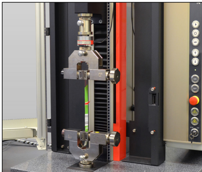
Schraub-Probenhalter Typ 8133 mit stufenlos und gestuft verstellbarer Gegenbacke, Fmax 1 kN
